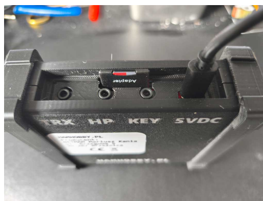
Abbildung 10 © Rudi Hube DF9PM Anschlussleiste des MorseLAB Mini mit microSDHC-Karte.
