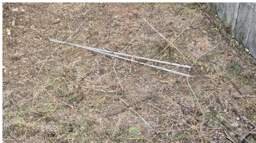
Abbildung 10 © Rudolf Klos DK7PE Sturmschaden: Überreste einer 50-MHz-Yagi-Antenne.
