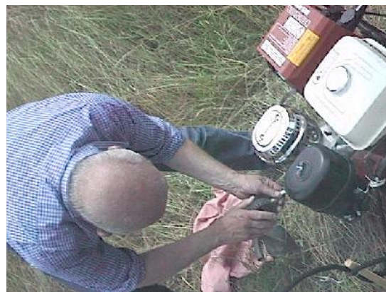
Der Stromerzeuger läuft nicht „rund“. Die Zündkerze wird sicherheitshalber getauscht.
