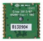
Nach sehr langer Recherche im Internet fand ich etwas passendes, was man auch innerhalb Europa erwerben kann: Global-Top Fox-1 ist ein quadratischer Baustein mit 16mm Kantenlänge. Direkt aufliegend ist die Keramik-Antenne aufgebracht. Damit ist die Bauhöhe ca. 5 mm.
