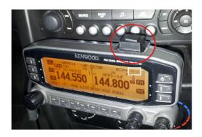
Beim ersten Start im Auto dauerte es schon 5 Minuten, bis sich der GPS-Chip das erste Mal eingerichtet hatte. Ich wurde schon ungeduldig. Zuletzt aber erleichtert, als das GPS Zeichen im Display des Funkgerätes anfing zu blinken – die Daten waren kompatibel.
